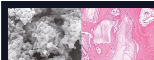
Analiza SEM - hydroksyapatyt składa się z małych cząstek, tworzących różne aglomeraty.
